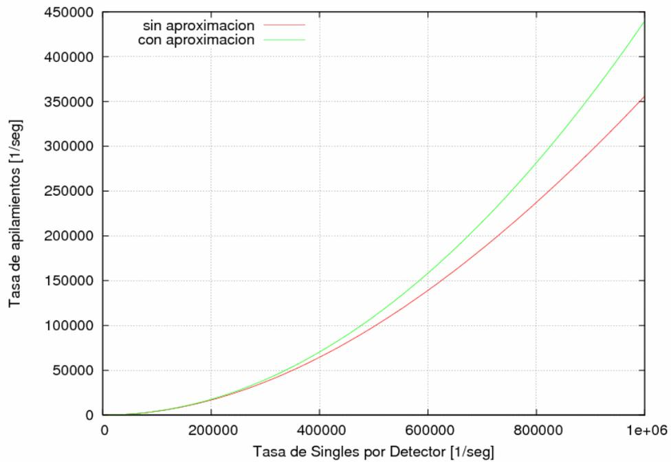
Figura 3: Estimación de la tasa de singles con apilamiento con y sin aproximación a uno de la exponencial para un tiempo de integración de 220 ns
