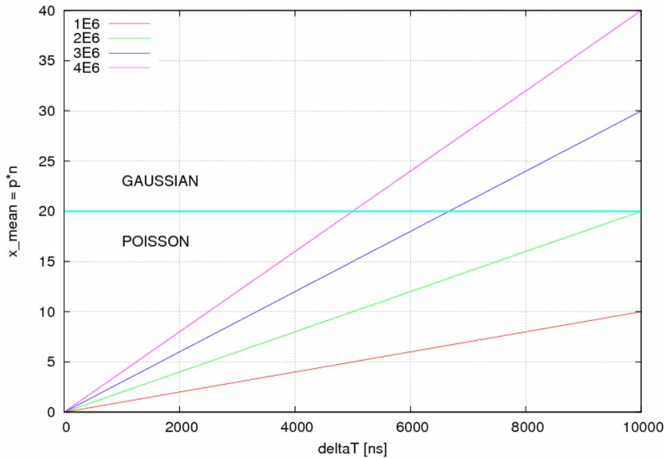
Figura 1: valor de la media frente a tiempo durante el cual pueden coincidir los fotones para diversos valores de tasa de singles medidos.
