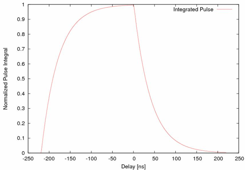
Figura 9: Fracción de energía que se integra del segundo fotón retardado frente al valor del retardo
