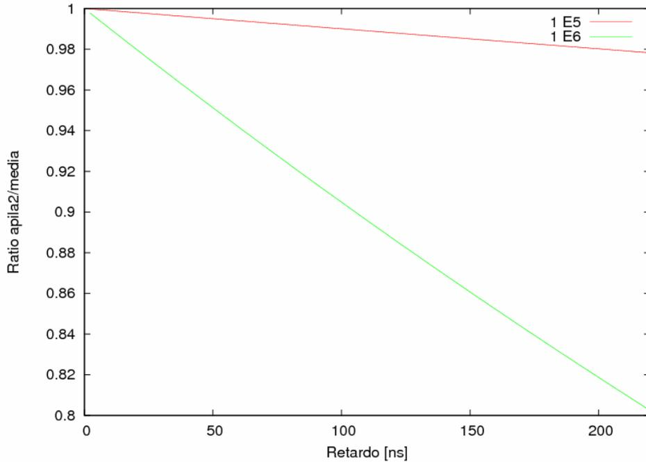
Figura 6: se muestra la fracción de singles con apilamiento que solo tiene dos pulsos apilados frente al retardo para diversas tasas de singles.
