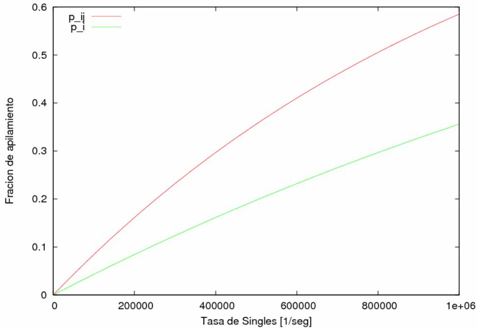
Figura 5: Tasa de singles y coincidencias con apilamiento frente a la tasa de singles para un tiempo de integración de 220 ns
