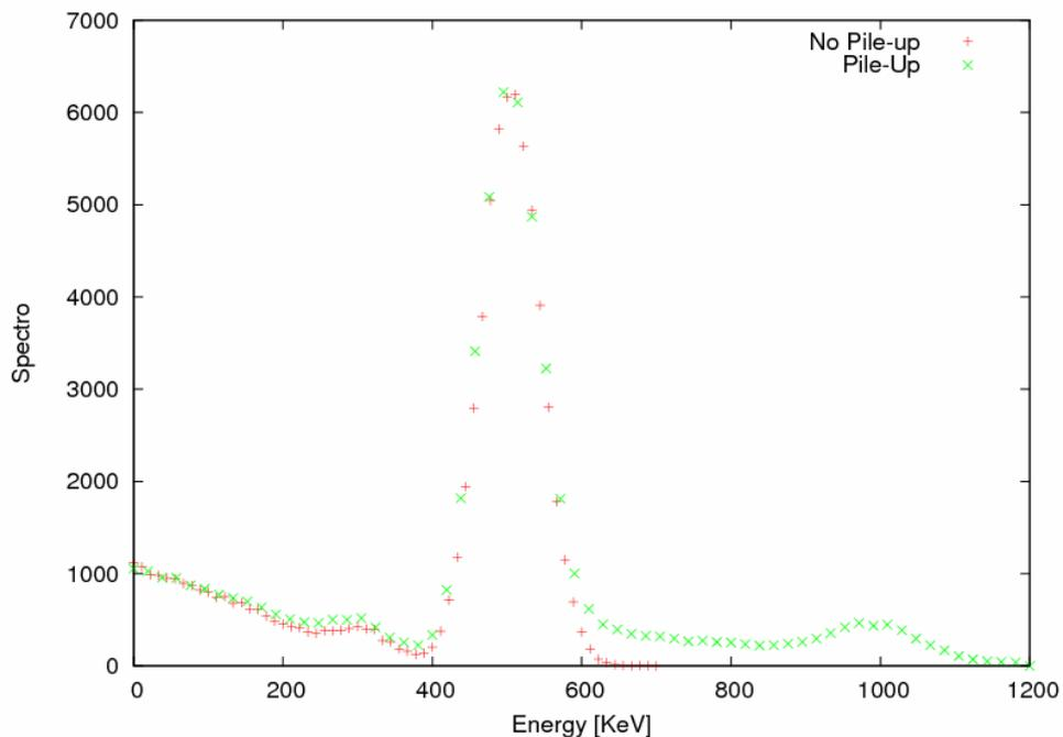
Figura 7: espectro de energía de los singles de coincidencias para un cilindro de 0,9 cm de diámetro en rPET simulado para baja ( $10^5$  Bq) y alta ( $4 \cdot 10^7$  Bq) actividad.
