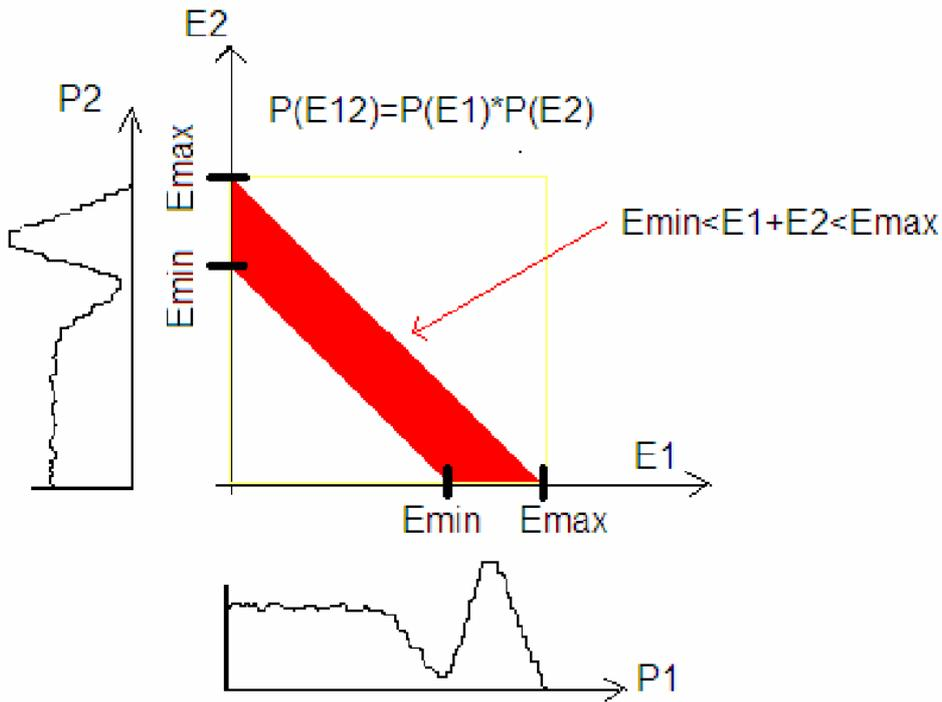
Figura 10: explicación visual de la condición que deben cumplir los dos fotones apilados para estar dentro de la ventana de energía.
