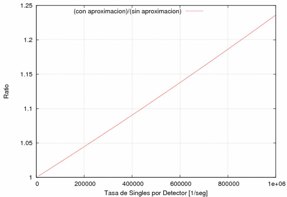
Figura 4: ratio entre la estimación de la tasa de singles con apilamiento con y sin aproximación a uno de la exponencial con un tiempo de integración de 220 ns.
