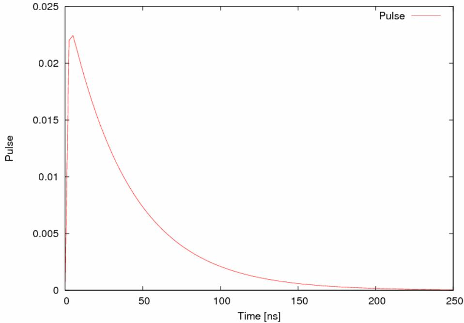
Figura 8: Pulso que se produce en el detector a la llegada de un fotón que deposita energía.  $T_{rise}=1$  ns,  $T_{fall}=40$  ns
