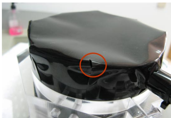
Figura 46. Fotografía del diseño F instalado, en la que se ve un agujero por el que puede escapar la luz.
