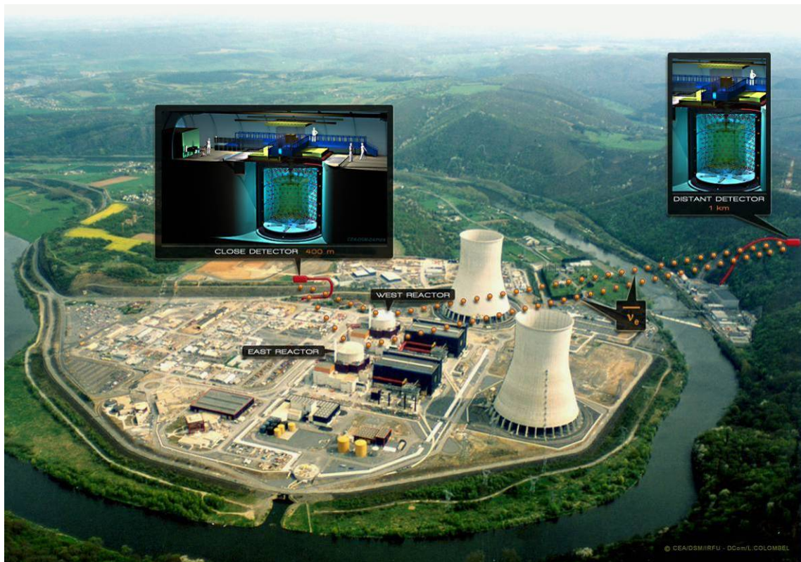
Figura 4. Fotografía de la central nuclear de Chooz (Francia). Se ha señalado la posición de los dos reactores y la de los dos detectores que conforman el experimento Double Chooz.
