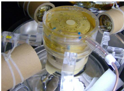
Figura 39. Forma de la base del PMT de Double Chooz. Se puede modelizar como un cilindro, de cuya superficie lateral sale perpendicularmente otro cilindro de radio menor (la salida del cable). Alrededor de la base se observa la estructura mecánica que soporta el PMT y en la que se fijará la cubierta.
