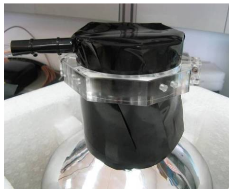
Figura 45. Diseño F instalado en el PMT.
