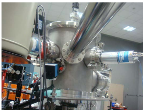
Figura 10. Nueva cámara en la línea multipropósito 2. A la izquierda vemos el detector de Ge y la cámara de vídeo y a la derecha el detector de \text{LaBr}_3 .
