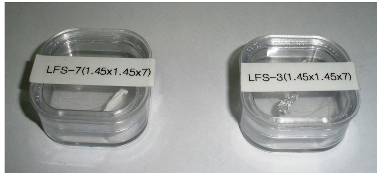
Fig. 3.18: Cristales de LFS. A la izquierda se aprecia el LFS-7, y la derecha el LFS-3.
