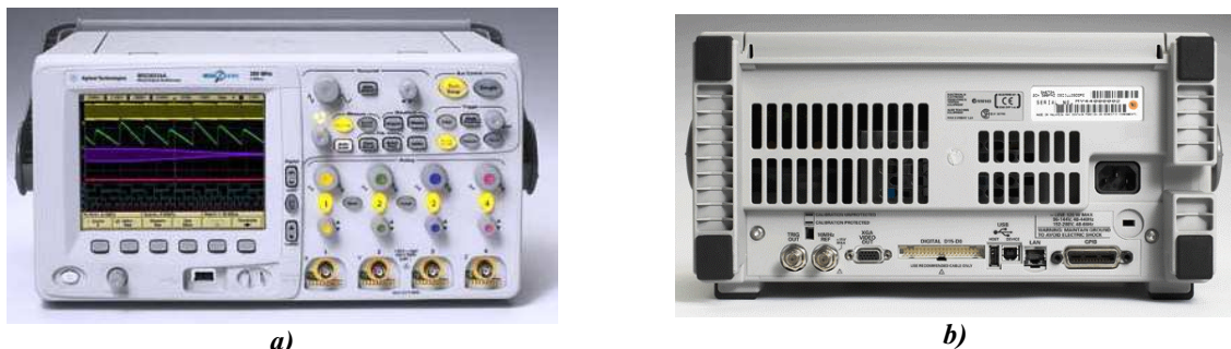
Fig. 2.20: Osciloscopio Agilent DSO6104A. a) Cara Frontal; b) Cara Posterior.
