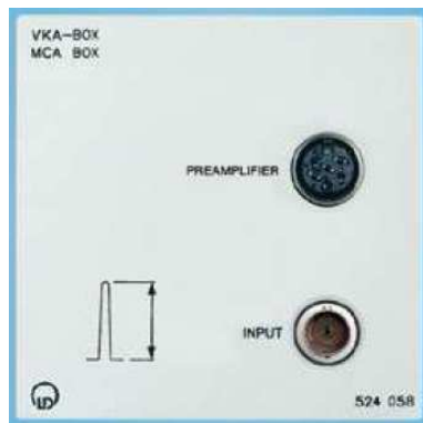
Fig. 3.9: Sistema de Adquisición de datos. a) MCA box de CassyLab; b) Pocket box
