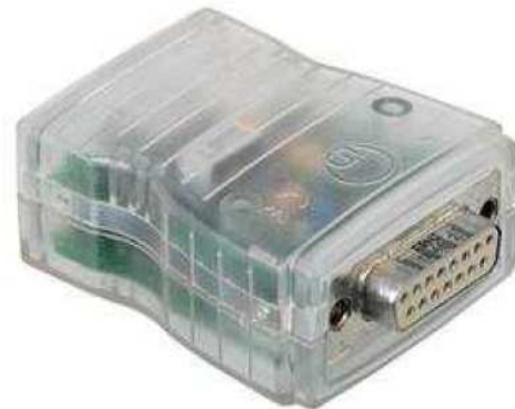
Fig. 3.9: Sistema de Adquisición de datos. a) MCA box de CassyLab; b) Pocket box
