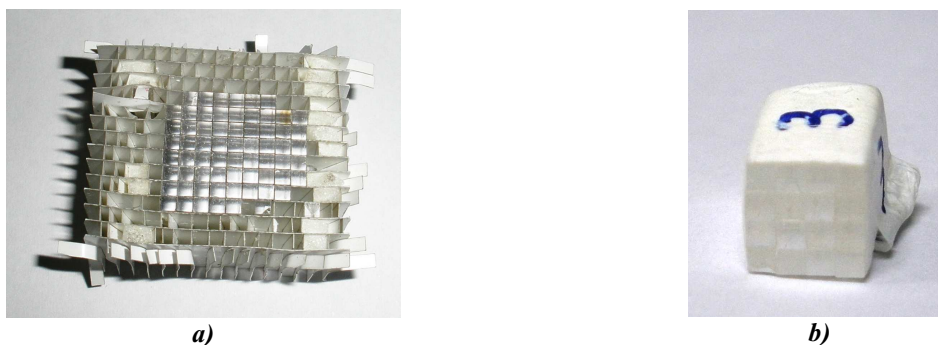
Fig. 5.23: Matrices de cristales de MLS de 1.5x1.5x12 mm. a) Matriz “vieja” de PET (62 cristales); b) Matriz 4x4 de cristales.
