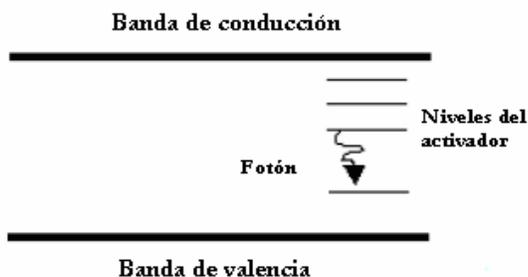
Figura 5-6: Esquema de la estructura de bandas de un material centelleador.
