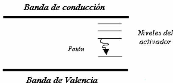
Figura 11. Estructura de bandas electrónicas de un cristal inorgánico
