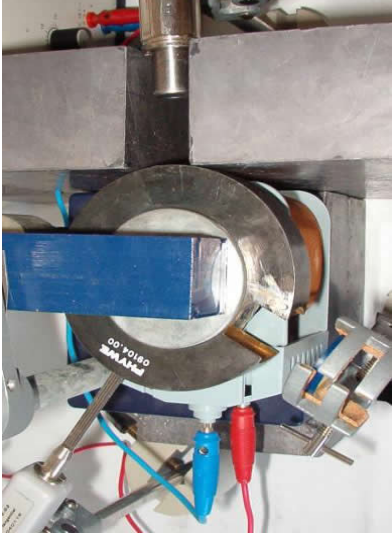
Fotografías del montaje experimental para la detección de radiación beta mediante un espectrómetro magnético.
