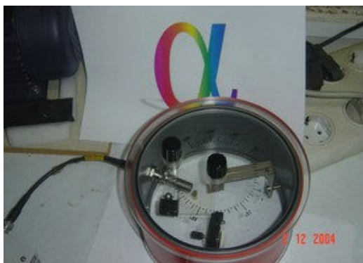
Imagen del montaje experimental para la determinación del espectro de emisión alfa de una muestra radioactiva.
