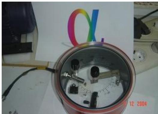
*Imagen del montaje experimental para la determinación del espectro de emisión alfa de una muestra radioactiva.*
