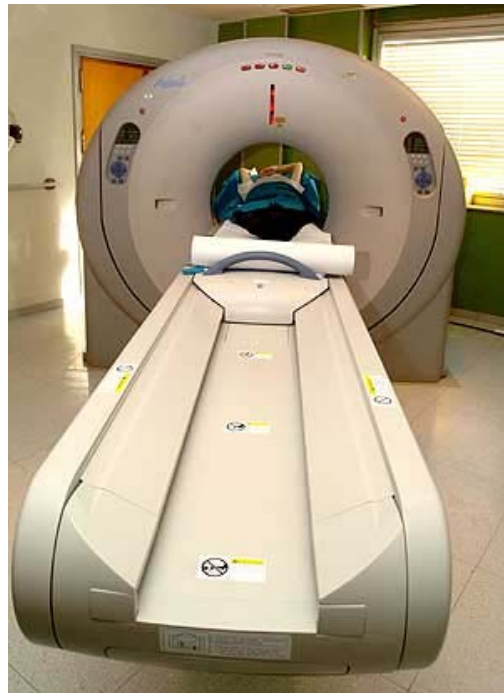
Figura 4. Aspecto externo de un escáner CT. Podemos distinguir la camilla y el Gantry.
