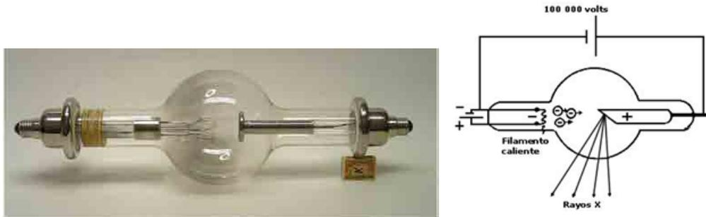
Figura 2.14: Fotografía (izquierda) y esquema (derecha) de un tubo de rayos X [56] [58].
