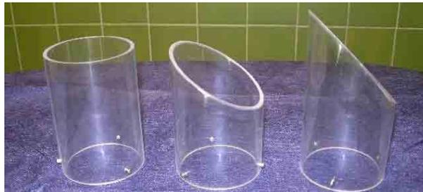
Figura 2.10: Ejemplo de aplicadores RIO de metacrilato de 7cm de diámetro. Se aprecia que uno de ellos está cortado de forma recta (izquierda) mientras que los otros dos presentan un corte oblicuo o bisel de 30° (centro) y de 45° (derecha) [45].
